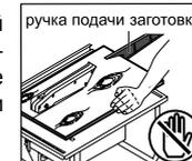
При необходимости косо пиления прижмите заготовку к угловому упору. При отрегулированной ширине В пиления уприте заготовку в направляющую. Для подачи заготовки используйте скольжение упора.
