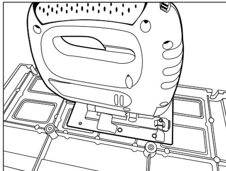
При необходимости, установите в отверстие 3 лобзик (с нижней стороны основания), используя прилагаемый фиксатор.
