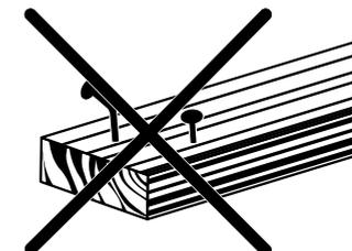
Перед началом работы убедитесь в отсутствии в заготовке металлических включений (гвозди, шурупы и т.д.)
