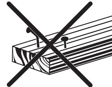
Перед началом работы убедитесь в отсутствии в заготовке металлических включений (гвозди, шурупы и т.д.)
