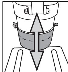
При необходимости сверления заготовки под углом, отпустите болт крепления стола на кронштейне и отрегулируйте по шкале кронштейна положение рабочего стола **2** в соответствии с необходимым углом сверления. Затяните болт.
